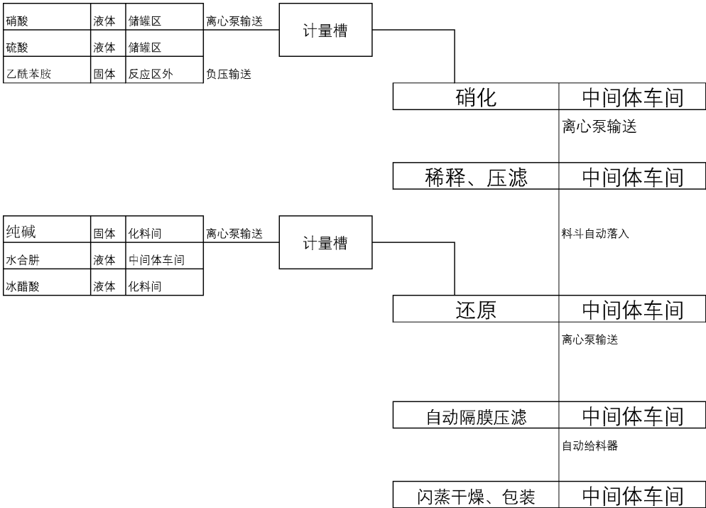
图 3.5.2-5 对氨基乙酰苯胺产品流程图
