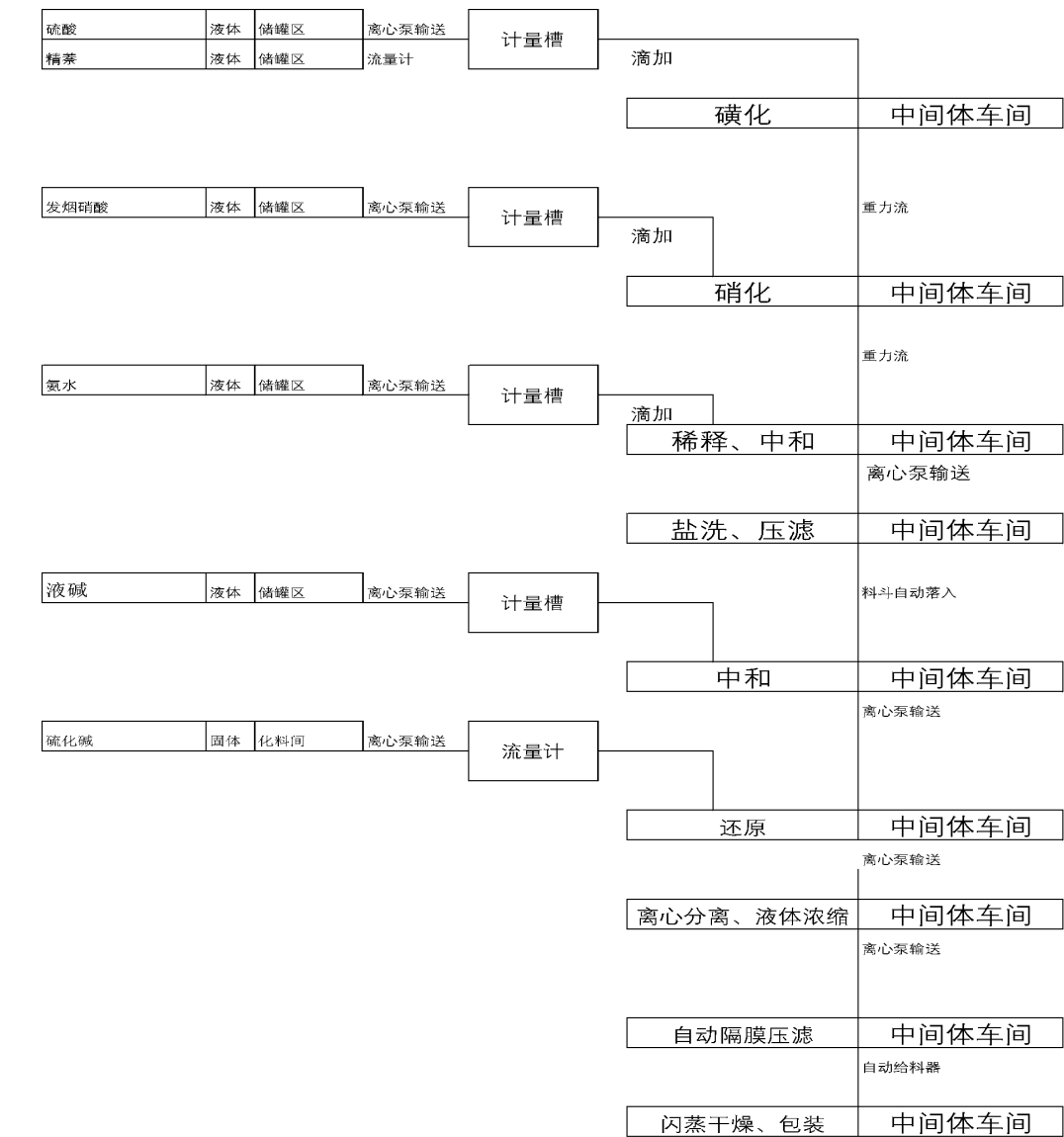
图 3.5.2-2 1,6,1,7 混克产品工艺流程图
