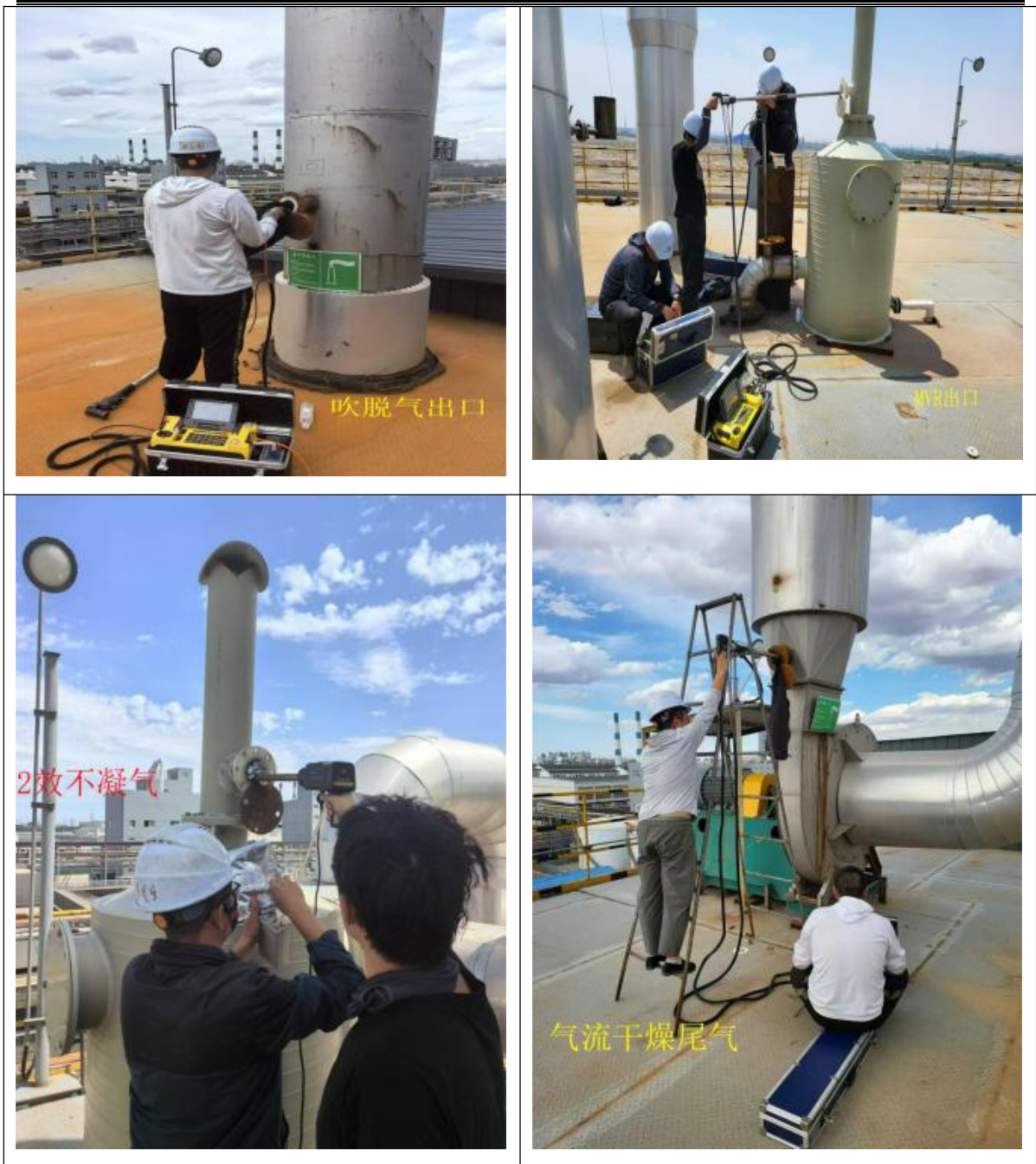
图 4.1.1-1 萘酚β盐浓缩液废水处理装置有组织排放废气（标明名字）
